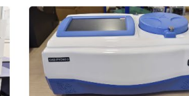
Pycnomètre : Mesure de densité
