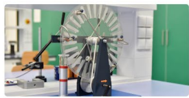
Machine électrostatique de Wimshurst (à induction électrostatique)
