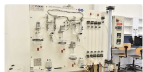
Banc d'étude des réacteurs continus (à piston, tubulaire, agité, en cascade)
