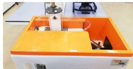
Impact d'un jet sur un obstacle - Théorème d'Euler
